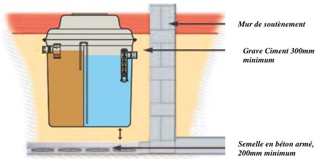
Figure #5 : Contraintes liées à la pente du terrain
